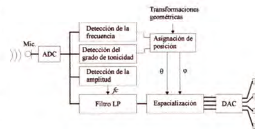
Figura 2: Esquema de implementación de módulo de espacialización en función de la altura, la dinámica y el grado de tonicidad de los eventos sonoros
